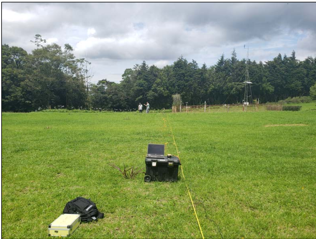
Fotografía 4: Ejecución de sondeo MASW.
