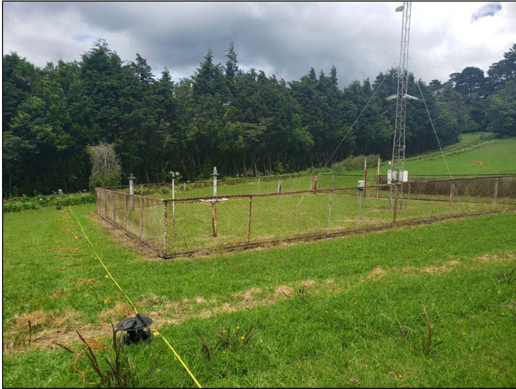
Fotografía 3: Ejecución de sondeo MASW.
