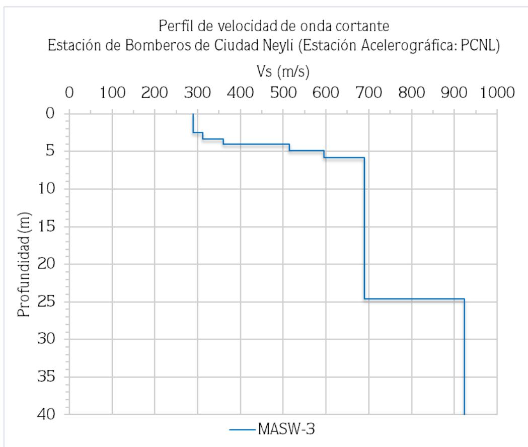
**Figura 4. Perfil de velocidad de onda cortante**
