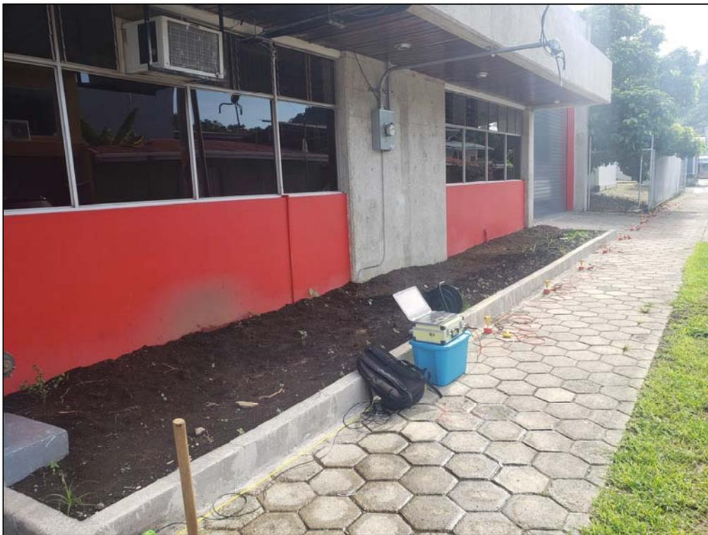
**Fotografía 2: Ejecución de ensayo MASW-3**
