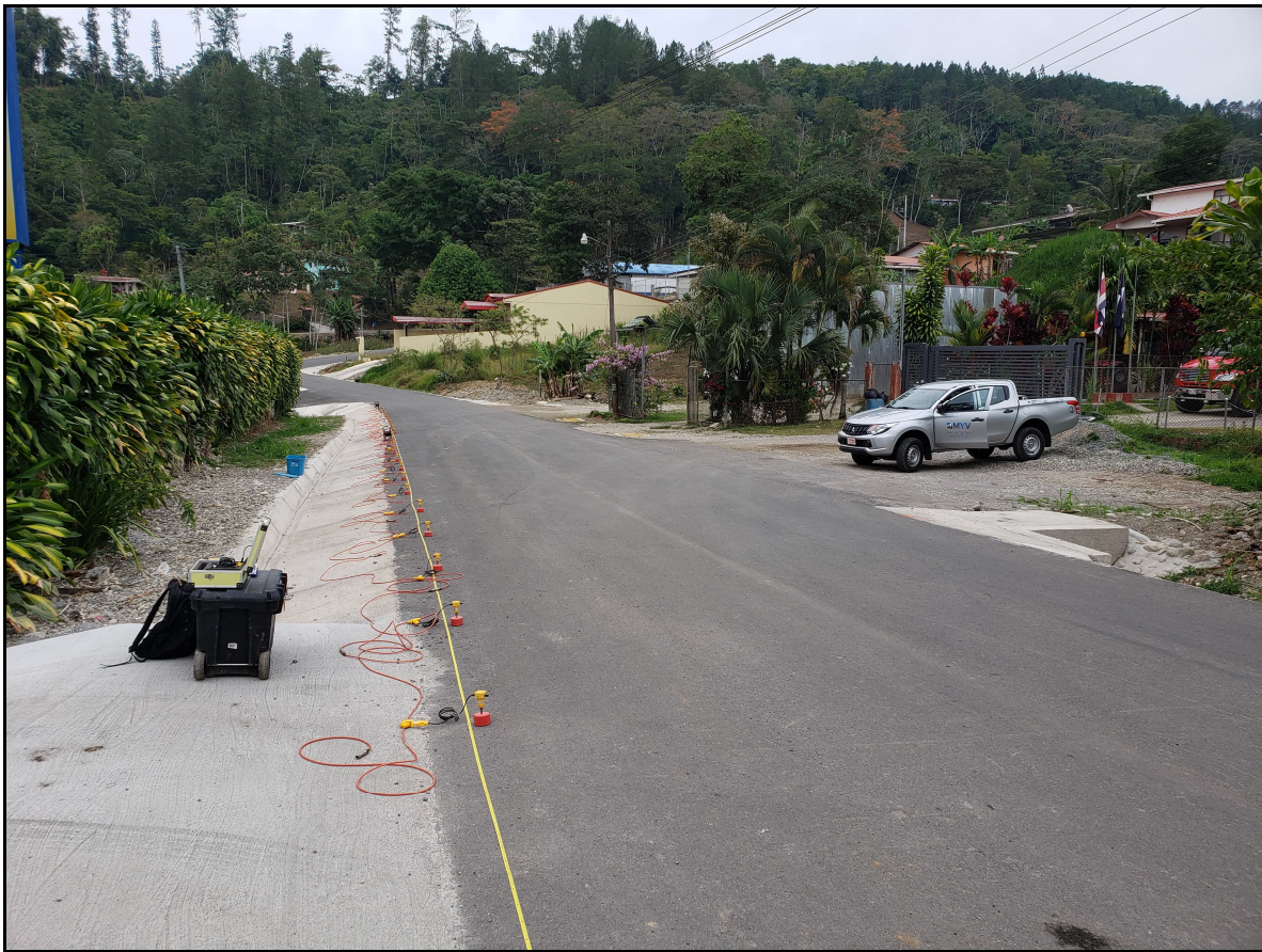
Fotografía 1. Ejecución del ensayo MASW-3.
