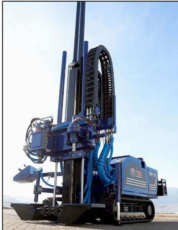
Figura 2. Máquina para perforación a rotación utilizada en las pruebas.
