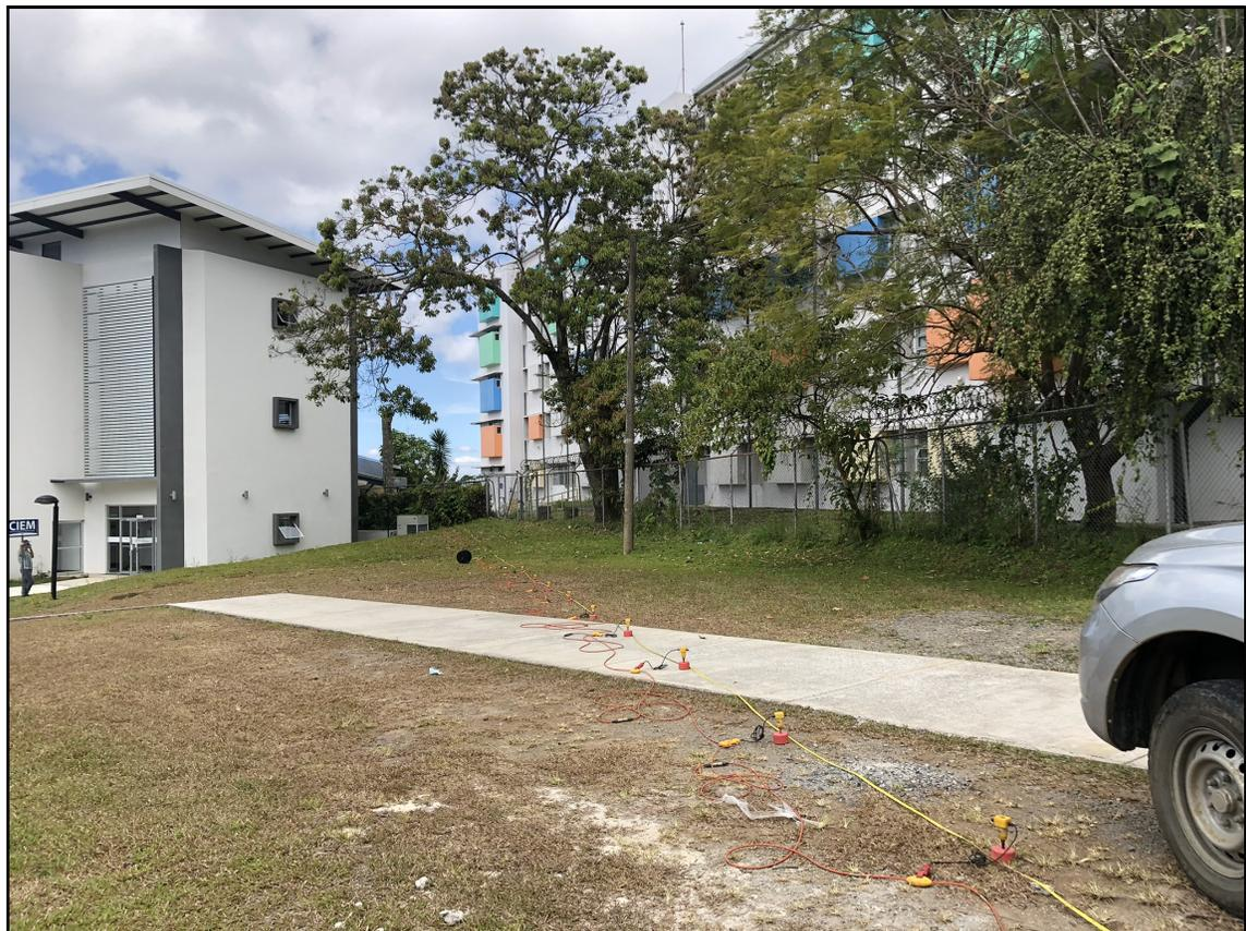
**Fotografía 4. Ejecución del ensayo MASW-2, Sitio #2.**
